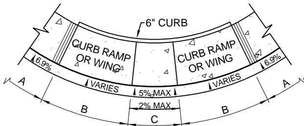
**TYPICAL GUTTER TRANSITION AT CURB RAMP**
