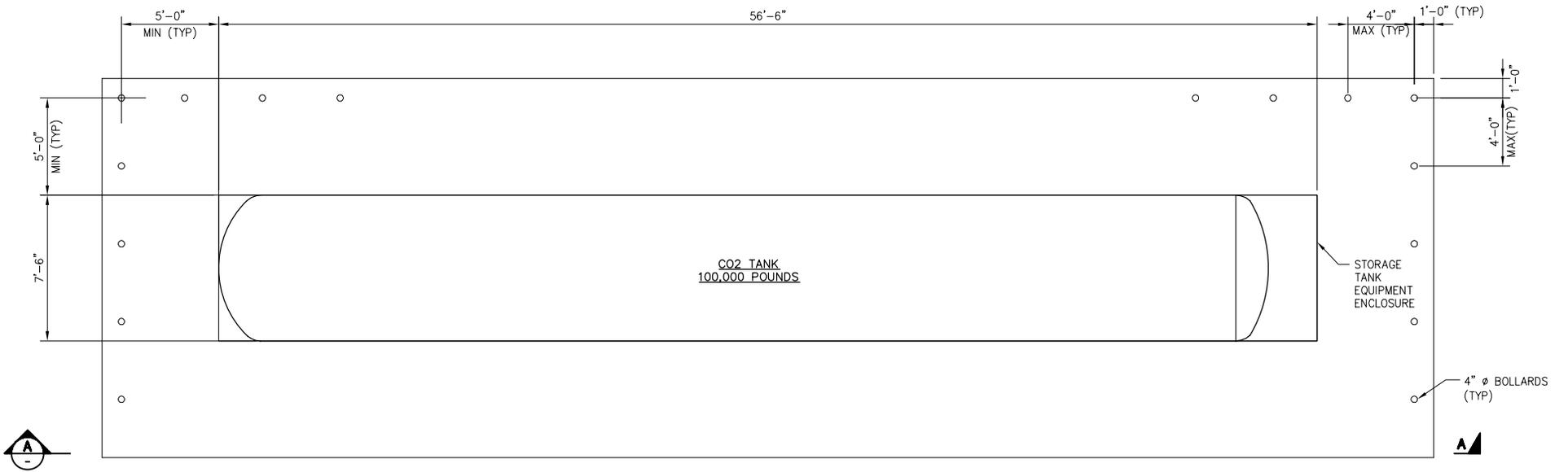
**CARBON DIOXIDE STORAGE TANK - PLAN**
